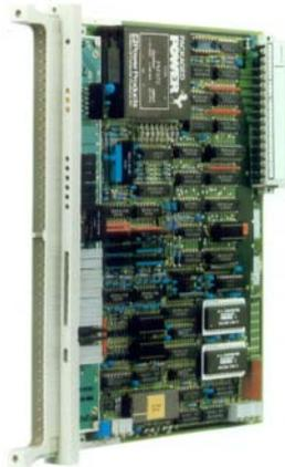
**Fig. 22.5 Analog IO Module**
