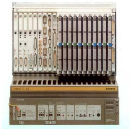
**Fig. 22.4 A mini PLC System**
