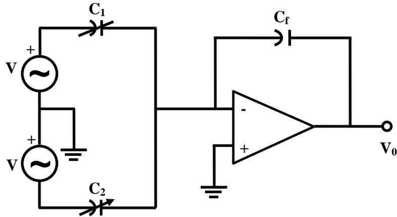
**Fig. 6 A capacitance amplifier.**
