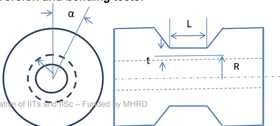
**Fig. 4.2.1: Torsion test specimen**
