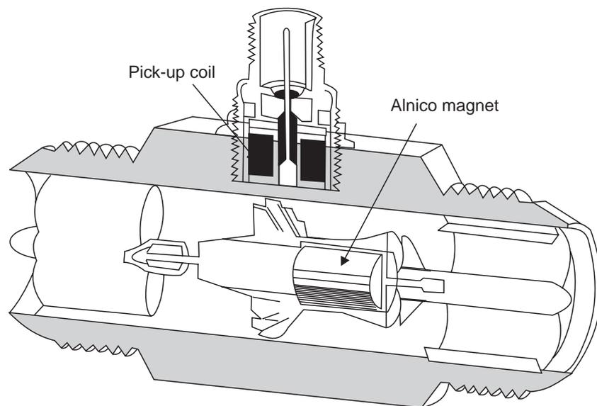
Fig. 1.34 Turbine Flow meter
