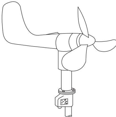
**Fig. 1.82** Impeller-anemometer.
