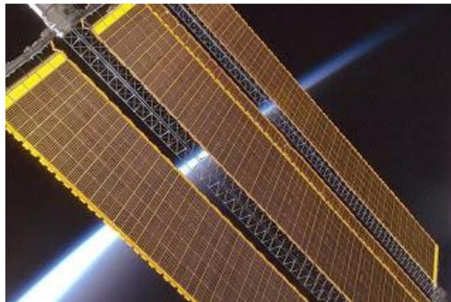
*A PV module on the ISS.*
