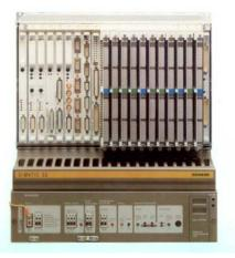
Fig. 22.4 A mini PLC System
