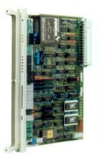
Fig. 22.5 Analog IO Module
