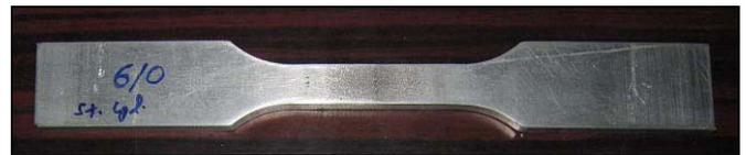
**Fig. 5** Tensile Specimen
