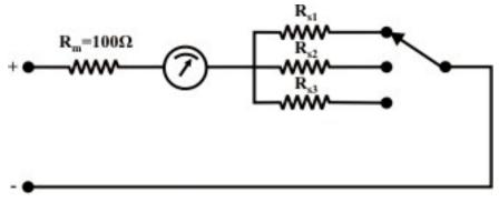
Fig. 42.6: Multirange voltmeter.
