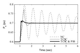
Fig. 29 Variation of electrical power  $P_e$ : Case-3
