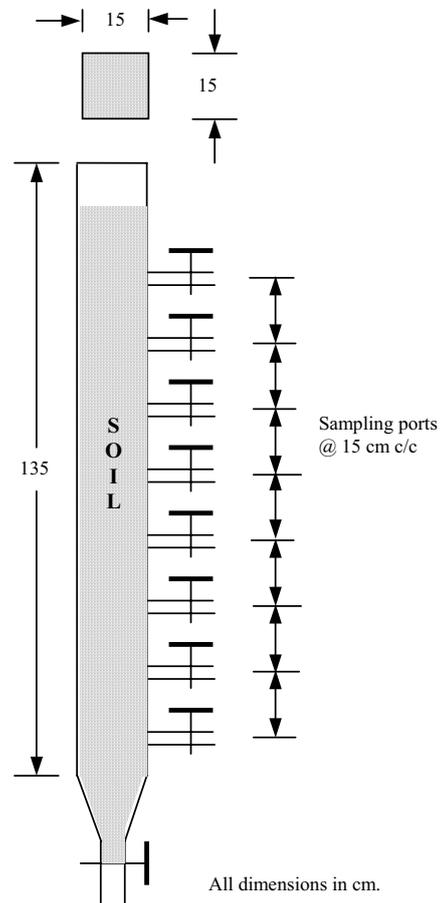
Fig. 1 Column apparatus
